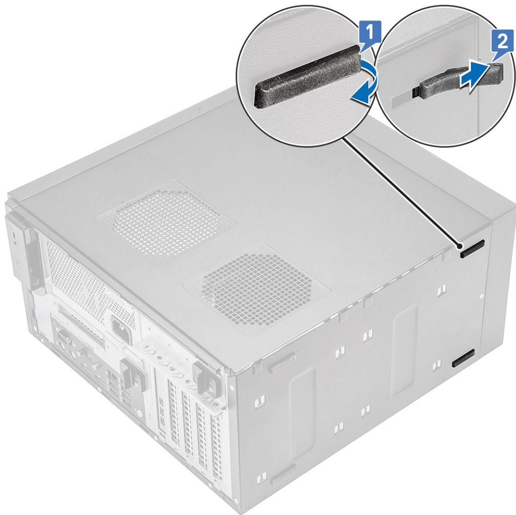
Afbeelding 4. Voorste rubberen voetjes verwijderen
