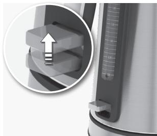
**4. Die Abdeckung schließen** und sicherstellen, dass sie einrastet. Andernfalls funktioniert die automatische Abschaltung nicht zuverlässig. **Den Wasserkocher auf die Basis setzen.** Den EIN/AUS-Schalter herunterdrücken; die Anzeige leuchtet auf und der Wasserkocher beginnt mit dem Erhitzen.
