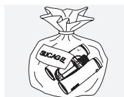
Lorsque les jumelles sont mouillées, il faut au préalable les sécher. Dans les zones tropicales ou dans des régions où règne une forte humidité ambiante, il vaut mieux entreposer vos jumelles dans un étui étanche à l'air doté d'un produit absorbant l'humidité (du type Silicagel).
