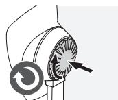
Premere il perno energeticamente e ruotarlo leggermente in senso orario fino a che non scatta in posizione.
