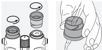
Bei starker Verschmutzung (z. B. Sand) sind die Drehäugennmuscheln komplett abschraubar und somit einfachst zu reinigen.
