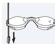
Pour attacher le capuchon protecteur pour oculaire, passez d'abord la courroie dans la boucle du capuchon.
