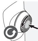
Pressez le bouton vers l'intérieur et tournez-le dans le sens inverse des aiguilles d'une montre (90°).
