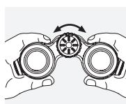
Durch Drehen des Fokussierrades können Sie jedes Objekt von der kürzesten Einstellentfernung (siehe technisches Datenblatt) bis unendlich scharf stellen.
