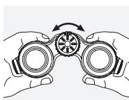
Ruotando la rotella di focalizzazione sarà possibile ottenere un'immagine nitida di qualsiasi oggetto posto ad una distanza ridotta (vedi scheda technical) fino all'infinito.
