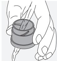
Bij sterke verontreiniging (bijv. zand) kan de oogklep er compleet afgeschroefd worden zodat het oculair eenvoudig kan worden schoongemaakt.
