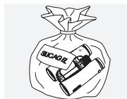
Om tubkikaren blir våt, bör den torka först. Vid längre förvaring i tropikerna då luftfuktigheten är hög är en lufttät påse den bästa platsen gärna tillsammans med något fuktabsorberande (t.ex. kiselkulor).
