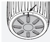
Utilisation avec une acuité visuelle identique pour les deux yeux : Le réglage de la correction dioptrique est réglé sur « zéro ».
