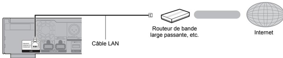
Utilisez des câbles LAN droits de catégorie 5e ou supérieure (STP) pour connecter les appareils périphériques.
