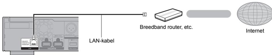
Gebruik rechte LAN-kabels van categorie 5e of hoger (STP) als u een aansluiting op randapparatuur tot stand brengt.
