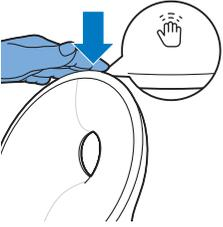
Als u 's nachts wakker wordt, kunt u een gedimd licht aanzetten door boven op het apparaat te tikken. Dit gedimde, subtiel oranje licht is net voldoende om uw weg te vinden in het donker. U kunt de middernachtlamp uitzetten door nogmaals boven op het apparaat te tikken.
