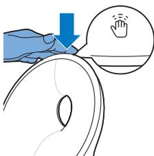
Tip: Als de lamp aan staat, kunt u deze ook uitzetten door één keer boven op de Sleep & Wake-Up Light te tikken. Alle actieve programma's worden gestopt. De ingestelde alarmen zijn nog steeds geactiveerd.
