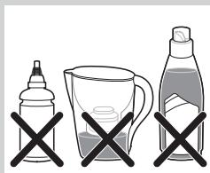
**Attention : N'utilisez pas d'eau parfumée, d'eau provenant du séchage, de vinaigre, d'amidon, de détartrants, de produits d'aide au repassage ou d'autres agents chimiques dans le réservoir d'eau car ils peuvent entraîner l'écoulement de gouttes d'eau de la semelle, des taches marron ou des dommages à votre appareil.**
