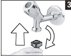
**3** Nach dem Anschluss der Schläuche öffnen Sie die Wasserzulaufe (Hähne) komplett; überzeugen Sie sich davon, dass kein Wasser an den Anschlussstellen austritt.
