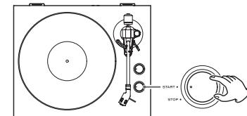
• Wenn sich der START/STOP-Schalter in der START-Position befindet, beginnt der Plattenteller sich zu drehen und die blaue LED leuchtet.
