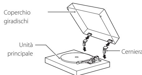
**1 Inserire completamente le cerniere nei supporti alle estremità destra e sinistra della parte posteriore dell'unità principale.**
