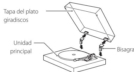
**1 Inserte las bisagras por completo en las sujetaciones situadas en los extremos izquierdo y derecho de la parte posterior de la unidad principal.**
