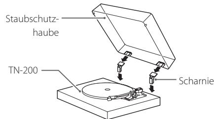
**1** Setzen Sie die Scharniere in die linken und rechten Scharnierbeschläge an der Rückseite des TN-200 ein.
