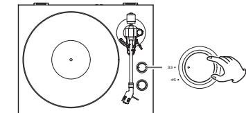
**5** Drehen Sie den START/STOP-Schalter in die START-Position, um den Plattentellerantrieb zu starten.
