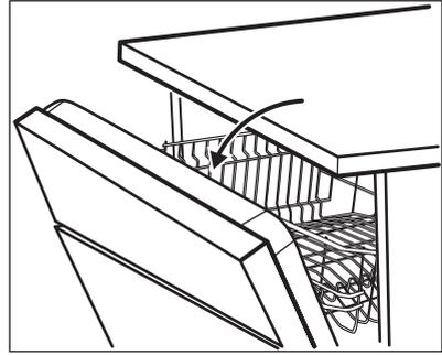
**i** Tijdens de werking van de droogfase, wordt de deur van het apparaat door een instrument geopend. De deur blijft op een kier.
