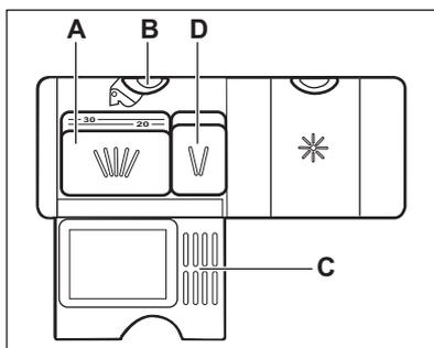
1. Druk op de ontgrendelknop (**B**) om de deksel te openen (**C**).
