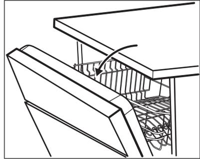
**i** Durant la phase de séchage, un dispositif ouvre la porte de l'appareil. Elle est alors maintenue entrouverte.
