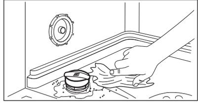
5. Tournez le couvercle du réservoir de sel régénérant vers la droite pour refermer le réservoir de sel régénérant.
