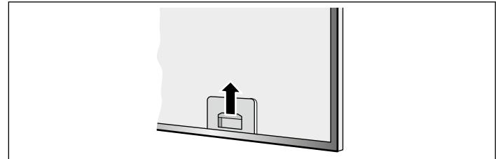
1. Verriegelung der Metallfettfilter öffnen und die Filter aus der Halterung entnehmen.
