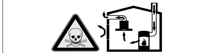
Raumlufthaftige Feuerstätten (z.B. gas-, öl-, holz- oder kohlebetriebene Heizergeräte, Durchlauferhitzer, Warmwasserbereiter) beziehen Verbrennungsluft aus dem Aufstellraum und führen die Abgase durch eine Abgasanlage (z.B. Kamin) ins Freie.
