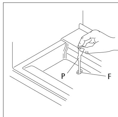
Durante l'uso normale, la brina viene eliminata automaticamente dall'evaporatore del vano frigorifero ogni volta che il motocompressore si arresta. L'acqua di sbrinamento giunge attraverso un condotto in un apposito recipiente posto sul retro dell'apparecchiatura, sopra il motocompressore, dove evapora.
