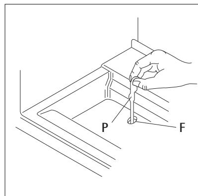
Bei normalem Betrieb wird Reif bei jedem Anhalten des Motorkompressors automatisch aus dem Verdampfer des Kühlschranks entfernt. Das Tauwasser läuft durch eine Rinne in einen
