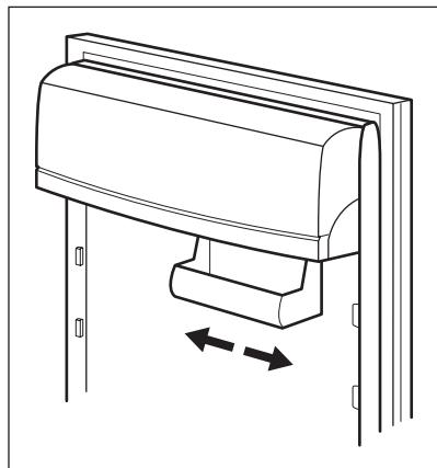
Le modèle est équipé d'un compartiment de rangement réglable, qui est fixé sous un balconnet de porte et qui peut glisser latéralement.
