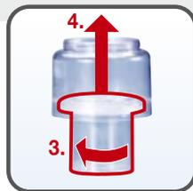
Den Wasserfilter abschrauben und öffnen
