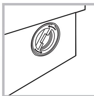
2. Drehen Sie den Deckel gegen den Uhrzeigersinn ab (siehe Abbildung): es ist ganz normal, wenn etwas Wasser austritt;
