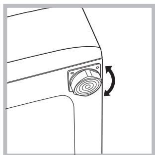
2. Sollte der Boden nicht perfekt eben sein, müssen die Unebenheiten durch An- bzw. Ausdrehen der vorderen Stellfüße ausgeglichen werden (siehe Abbildung), der auf der Arbeitsfläche zu ermittelnde Neigungssgrad darf  $2^\circ$  nicht überschreiten.
