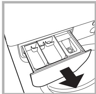
Heben Sie die Schublade leicht an und ziehen Sie sie nach vorne hin heraus (siehe Abbildung). Spülen Sie sie regelmäßig unter fließendem Wasser gründlich aus.
