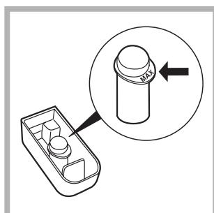
Diese Funktion ermöglicht das Entfernen von hartnäckigen Flecken. Setzen Sie die mitgelieferte, zusätzliche Kammer 4 in Kammer 1 ein. Bei der Dosierung des Bleichmittels darf der gekennzeichneten Höchststand "max" (siehe Abbildung) nicht überschritten werden.
