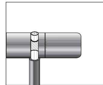
cable del altavoz se ha marcado un hilo con color o dándole forma. Atornille este cable de alimentación positivo con el borne rojo, y el otro hilo con el borne negro. Apriete con fuerza los tornillos manualmente. Para garantizar la polaridad correcta, compruebe también la conexión correcta en su amplificador. En este caso, el hilo marcado también corresponde al polo positivo (+), y el otro hilo corresponde al borne roscado negro (-).
