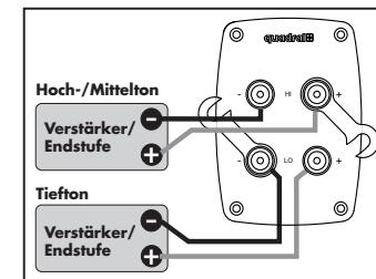
Beim Bi-wiring/Bi-amping Betrieb wird über die beiden unteren Schraubklemmen der Tiefoton - über die beiden oberen Schraubklemmen der Mittel-/Hochtonteil angesteuert.
