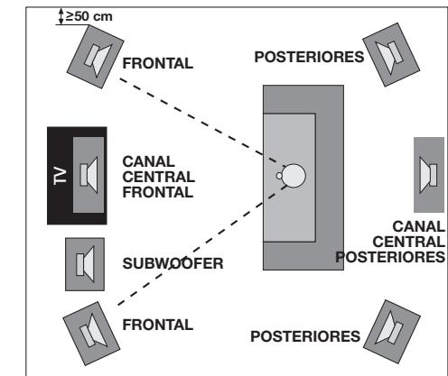
posible del televisor. Si no es posible colocarlo sobre el televisor, el altavoz central puede colocarse también en posición horizontal debajo del televisor, debiendo existir una distancia con respecto al suelo de 20 cm como mínimo. Además, recomendamos calcular el ángulo del altavoz central de forma que el tweeter esté orientado al oyente. Solo así podrá desplegar todo su potencial de sonido.
