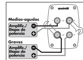
En el modo Bi-wiring/Bi-amping se controlan los graves a través de los dos bornes roscados inferiores, y los medios/agudos a través de los dos bornes roscados superiores.
