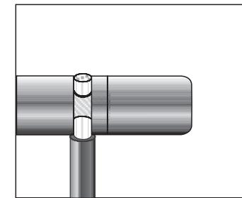
câble du haut-parleur, un fil est caractérisé par une couleur ou une forme spéciale. C'est la ligne positive que vous raccorderez à la borne rouge, l'autre fil étant relié à la borne noire. Resserrez les vis à fond. Afin de garantir une polarité correcte, vérifiez également que le raccordement à votre amplificateur est bien correct. Là aussi, le fil caractérisé est à relier au pôle (+), l'autre à la borne à vis noire (-).
