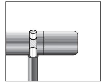
Klemme - die andere Ader mit der schwarzen Klemme. Ziehen Sie die Schrauben handfest an. Um die richtige Polarität zu gewährleisten, überprüfen Sie bitte auch den korrekten Anschluss an Ihrem Verstärker. Auch hier gehört die gekennzeichnete Ader an den (+)-Pol, die andere an die schwarze (-) Schraubklemme.
