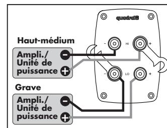
En mode bifilaire ou bi-ampli, les deux bornes à vis inférieures commandent le registre des graves, et les deux bornes supérieures celui des médiums et des aigus. Dans ces modes de fonctionnement, observez impérativement la polarité correcte et
