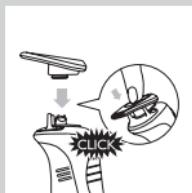
**2** 将修剪器从充填和充电座上的存放凹槽中拉出，并将其装回剃须刀（会听到喀哒声）。
