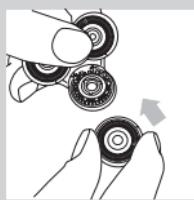
4 Làm sạch lưỡi dao cạo và nắp bảo vệ bằng bàn chải cẩn kẽm với máy.
