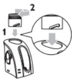
**5** 将盖子推回到充填和充电座上 (1) 顺时针转动盖子 (2) 以将其固定。
