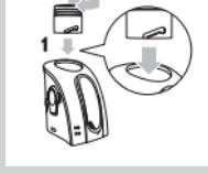
**6** 將補充暨充電座的上蓋放回，並以順時針方向旋轉旋轉上蓋，加以固定。
