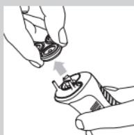
Gantikan unit pencukuran setiap tahun untuk mendapatkan hasil cukuran yang optimum. Hanya gantikan unit pencukur dengan Unit Pencukur Philips HS85.
