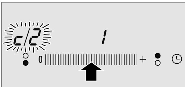
5. Appuyez à nouveau sur le symbole
