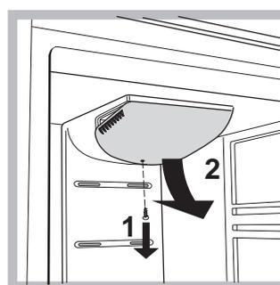
Accedere alla lampada togliendo la protezione come indicato in figura. Sostituirla facendo attenzione alla potenza massima indicata sulla protezione (10W, 15 W o
