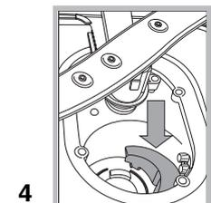
Após a limpeza dos filtros, monte novamente o grupo filtrante e coloque-o correctamente na sua posição; isto é fundamental para o bom funcionamento da máquina de lavar louças.
