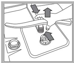
Um den unteren Sprüharm abzunehmen, drücken Sie die beiden seitlichen Zungen nach unten und ziehen dann den Arm nach oben hin ab.
