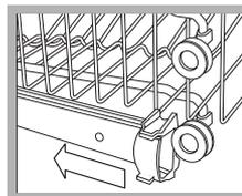
Öffnen Sie den rechten und linken Arretierstift der Korbführungen und ziehen Sie den Korb heraus; schieben Sie ihn in Hoch- oder Niedrigstellung ein; lassen Sie ihn über die Führungen nach hinten gleiten und schieben Sie hierbei auch die Vorderräder ein; schließen Sie die
