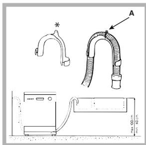
Der spezielle Kunststoffbügel\* erleichtert Ihnen eine optimale Anbringung. Befestigen Sie den Kunststoffbügel so an der Mauer, dass er nicht verrutscht und somit kein Wasser außerhalb des Ablaufs austritt.
