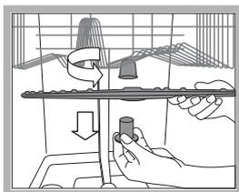
Om de bovenste sproeiarm uit elkaar te halen dient u de plastic dop linksom los te schroeven. De bovenste sproeiarm moet worden gemonteerd met de gaten naar boven gericht.
