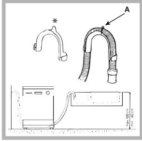
El codo\* de plástico especial facilita una colocación óptima: fije firmemente el codo a la pared para evitar que el tubo se mueva y vierta agua fuera de la descarga. La parte del tubo marcada con la letra A debe estar a una altura comprendida entre 40 y 100 cm. del piso (ver la figura).
