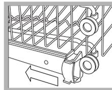
Abra os trincos das guias do cesto à direita e à esquerda e retire o cesto; disponha-o no alto ou em baixo, faça-o deslizar ao longo das guias até entrarem também as rodinhas anteriores e feche novamente os trincos (*veja a figura*).
