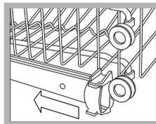
Abra los sujetadores de las guías del cesto, a la izquierda y a la derecha, y extráigalo; colóquelo arriba o abajo, hágalo deslizar a lo largo de las guías hasta hacer entrar también las ruedas delanteras y cierre los sujetadores (*ver la figura*).
