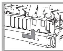
Ist der Korb mit "Dual Space"-Griffen ausgestattet (siehe Abbildung), ziehen Sie den Oberkorb bis zum Anschlag heraus, fassen die an den Korbseiten befindlichen Griffe mit den Händen, ziehen diese nach oben bzw. drücken sie nach unten, und lassen Sie den Korb daraufhin herab
