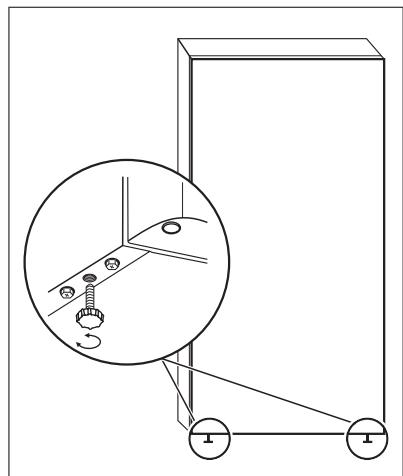
Bei der Aufstellung des Gerätes ist dieses waagerecht auszurichten. Dies lässt sich mit zwei Schraubfüßen am vorderen Sockel des Gerätes erreichen.
