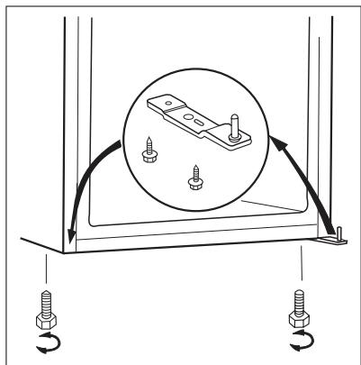
6. Lösen Sie die untere seitliche äußere Schraube, setzen Sie diese auf der anderen Seite ein und ziehen Sie sie fest.
