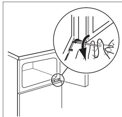
3. Verwijder de deuren door ze licht omhoog te trekken en verwijder daarna het scharnier.
