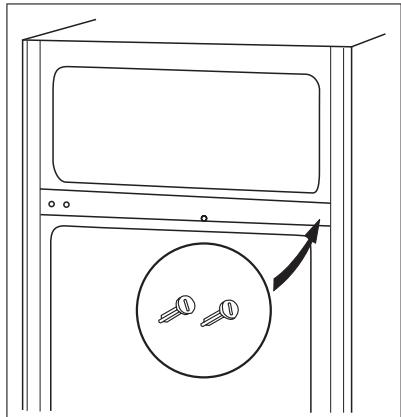
5. Lösen Sie beide Schraubfüße und die Schrauben am unteren Türscharnier. Bauen Sie das untere Türscharnier ab und bauen Sie dieses auf der gegenüberliegenden Seite ein.
