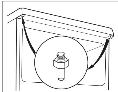
9. Plaats de deuren in de pennen en monter de deuren. Montere het scharnier.
