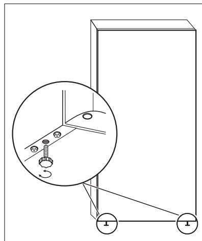
Zorg er voor dat het apparaat waterpas staat wanneer u het plaatst. Deze stand kan bereikt worden met de twee afstelbare voetjes die aan de voorkant en onderkant van het apparaat bevestigd zijn.
