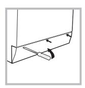
1. verwijder het afdekpaneel aan de voorkant van de wasautomaat met behulp van een schroevendraaier (zie afbeelding);
