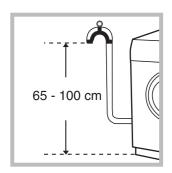
Verbindt de afvoerbuis, zonder hem te buigen, aan een afvoerleiding of aan een afvoer in de muur tussen de 65 en 100 cm van de grond af.
