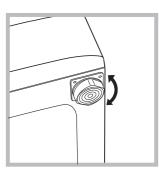
2. Pour compenser les irrégularités du sol, visser ou dévisser les pieds de réglage jusqu'à ce que l'appareil soit parfaitement à l'horizontale (il ne doit pas être incliné de plus de 2 degrés).
