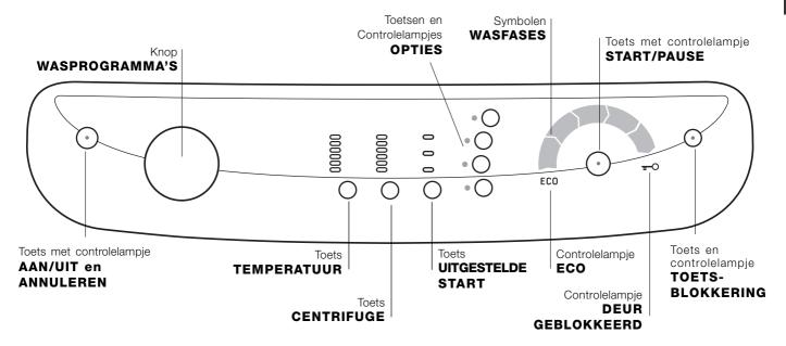
Toets met controlelampje (\*) AAN-/UIT en ANNU-LEREN: druk even op de toets om de wasautomaat aan of uit te zetten. Het groene controlelampje geeft aan dat de wasautomaat aanstaat. Om de wasautomaat tijdens de wascyclus uit te zetten moet u de toets langer, circa 2 sec., ingedrukt houden; als u de toets kort, of per ongeluk indrukt zal de wasautomaat niet uitgaan.
