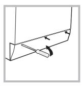
3. démonter le panneau situé à l'avant du lavelinge à l'aide d'un tournevis (voir figure).
