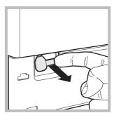
4. trek het lipje dat wordt aangegeven in de afbeelding naar voren totdat het plastic bandje loskomt; trek hem daarna naar beneden totdat u klik hoort, wat aangeeft dat de deur is geopend.
