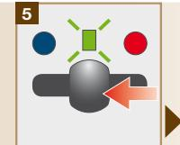
Selectieknop op positie . Controlelampje knippert elke 2 seconden ➤ machine is in ontkalkmodus. Wahlhebel auf . Statusleuchte blinkt alle 2 Sekunden. ➤ Maschine ist im Entkalkungsmodus.
