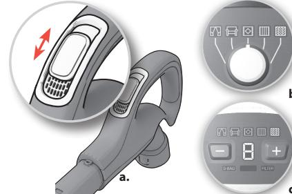
**9. Regolare la potenza di aspirazione.** Modelli con regolazione manuale. a) Utilizzare il controllo di aspirazione sul manico per ridurre velocemente il flusso d'aria b) Utilizzare la manopola sull'apparecchio per regolare la potenza di aspirazione c) Utilizzare il tasto + o - sull'apparecchio per regolare la potenza di aspirazione.\*
