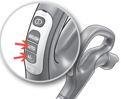
**10. Regolare la potenza di aspirazione. Modelli con comando a distanza.** L'aspirapolvere si avvia in modalità automatica (regolazione automatica della potenza). Per effettuare la regolazione manuale, premere il pulsante “-” (minimo) o il pulsante “+” (massimo). Per tornare alla modalità automatica, premere il pulsante AUTO.\*
