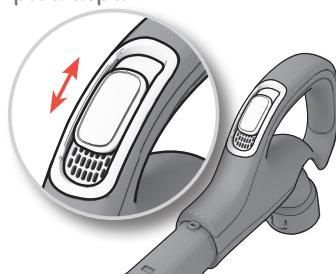
Sui modelli a controllo manuale, la valvola dell'aria può contribuire a ridurre rapidamente la potenza di aspirazione.
