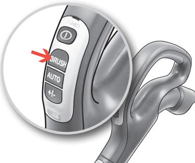
**11. Modelli con comando a distanza e bocchetta motorizzata Aeropro.** Per accendere e spegnere la bocchetta motorizzata, premere il pulsante BRUSH sull'impugnatura.\*
