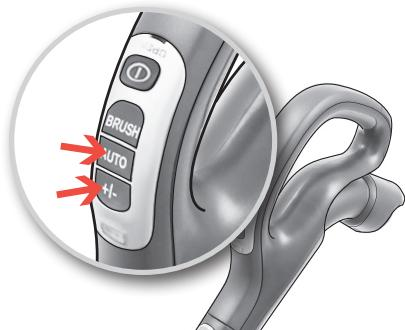
**10. Saugleistung einstellen. Modell mit Fernbedienung.** Beim Einschalten arbeitet der Staubsauger im Automatikmodus (automatische Leistungsregelung). Manuelles Einstellen durch Drücken der Taste „-“ (Minimum) oder „+“ (Maximum). Zum erneuten Wechsel in den Automatik-Modus den Schalter AUTO drücken.\*
