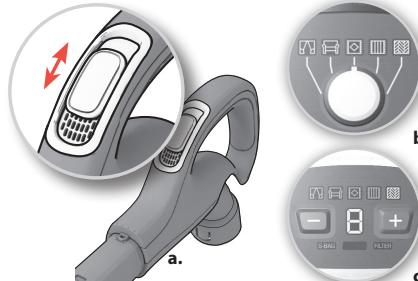
**9. Ajuste la potencia de aspiración.** Modelos con regulación manual. a) Utilice el control de aspiración del mango para reducir rápidamente el caudal de aire b) Utilice el mando giratorio de la aspiradora para ajustar la potencia de aspiración c) Utilice el botón + o - de la aspiradora para ajustar la potencia de aspiración.\*
