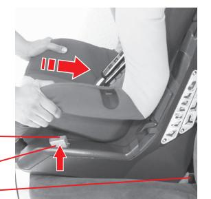
¶ Schieben Sie beide Rastarme 4 in die Einführhilfen 1, bis die Rastarme auf **beiden Seiten** einrasten. „KLICK!“
