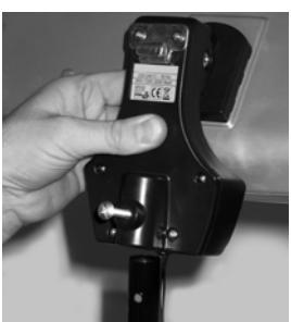
Draai de montageschroef (7) bijna helemaal uit de montagebeugel. Plaats het hoofd van de terrasstraler over het gebogen standaarddeel, zodanig, dat de schroef precies in het gat in de standaard valt. Draai de schroef nu goed vast. Het gebogen standaarddeel kan 360° draaien zodat de kop van de terrasstraler in elke richting kan wijzen. De elektrokabel kan worden vastgezet in de kabelhouder aan de standaard.
