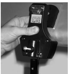
Dévissez la vis de montage (7) sur pratiquement toute sa longueur. Placez la tête du chauffage de terrasse par-dessus la partie courbée du socle, de telle façon que la vis s'emboîte parfaitement dans le trou du socle. Serrez à présent fermement la vis. La partie courbée du socle peut être orientée sur 360°. La tête du chauffage de terrasse peut donc être tournée dans n'importe quelle direction. Le câble électrique peut être fixé au support de câble du socle.
