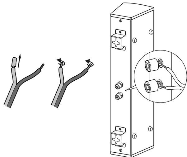
1. Teilen Sie die Litze an beiden Enden auf etwa 30 mm und entfernen Sie jeweils ca. 10 mm der Isolierung.
