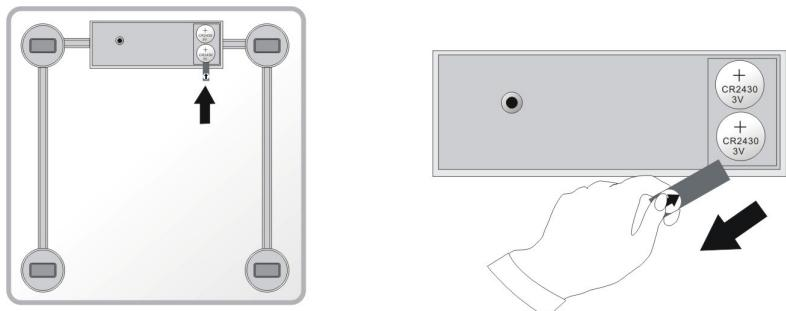
De batterijvakjes bevinden zich aan de onderzijde van de weegschaal. Open de batterijvakjes voordat u de weegschaal voor het eerst gebruikt, en haal het beschermende strookje eruit.
