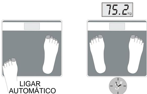
1. A balança ligará automaticamente, logo que se coloque em cima dela, ou pressione a plataforma.
