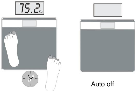
2. Tenez vous debout fermement sur la balance, elle s'allumera automatiquement et affichera le poids. La valeur du poids se stabilisera et se fixera, le chiffre qui apparaîtra alors, représente la masse corporelle. Cinq secondes après l'affichage de la valeur de la masse corporelle, la balance s'éteindra automatiquement.
