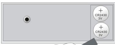
Os compartimentos para as pilhas estão situados na parte de trás da balança. Antes do primeiro uso, abra os compartimentos das pilhas da balança e retire a tira de protecção.
