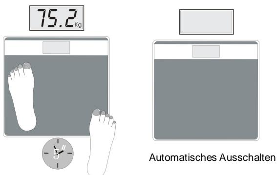
2. Stehen Sie ruhig auf der Waage; diese schaltet sich automatisch ein und zeigt Ihr Gewicht an. Der Anzeigenwert erhöht sich gleichmäßig und stoppt, wenn hinter dem Zahlenwert die Maßeinheit angezeigt wird. Dieser Wert ist dann das Ergebnis. Ungefähr 5 Sekunden nach der Anzeige des Gewichts schaltet sich das Gerät automatisch aus.
