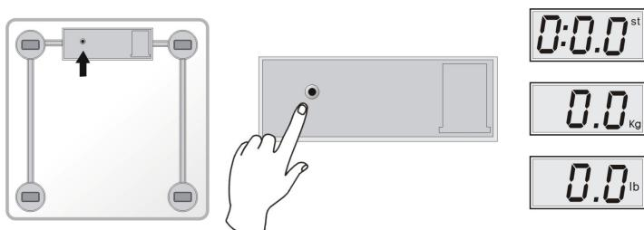
Drücken Sie, wenn das Gerät eingeschaltet ist, die Taste auf der Rückseite der Waage, um zwischen den Maßeinheiten kg, lb oder st zu wählen.
