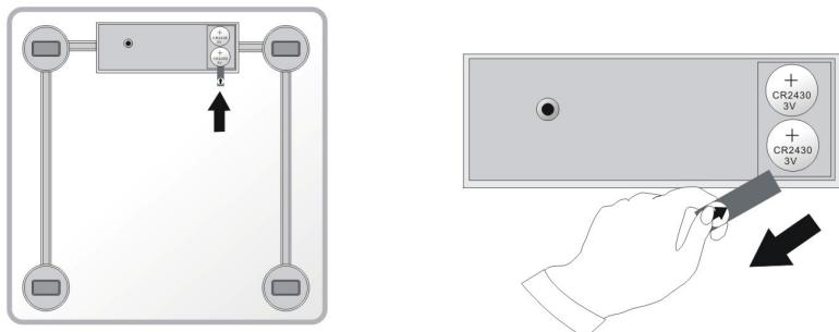
Le compartiment des piles de la balance est situé à l'arrière. Avant la première utilisation, ouvrez le compartiment des piles de la balance et retirez le papier de protection
