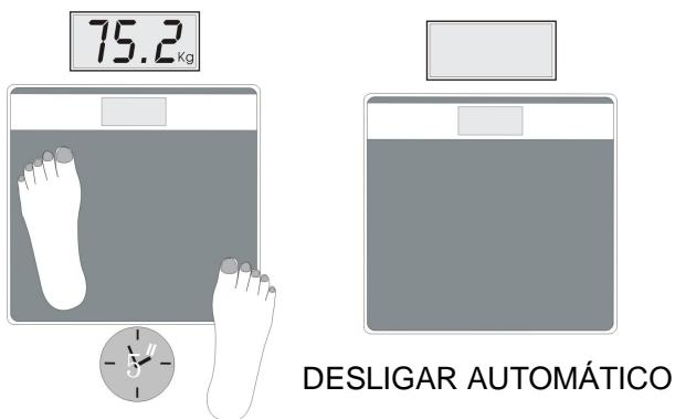
2. Permaneça de pé e sem se mexer; a balança ligará automaticamente e mostrará o peso. Este permanecerá fixo, quando a unidade corresponder ao valor do peso e será esse o resultado. A balança desligar-se-á automaticamente, cerca de 5 segundos depois do peso aparecer.
