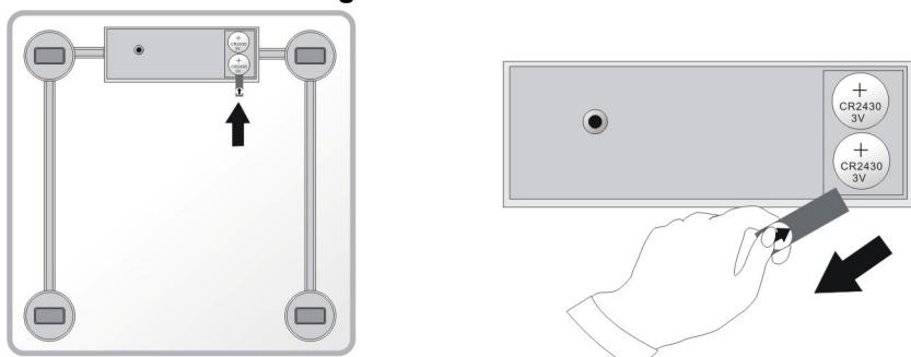
Gli alloggiamenti per le batterie della bilancia sono sul retro. Prima di usarla per la prima volta, aprire gli alloggiamenti delle batterie della bilancia e rimuovere la pellicola protettiva
