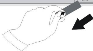
Das Batteriefach der Waage befindet sich auf der Rückseite. Öffnen Sie das Batteriefach vor dem Erstgebrauch und entfernen Sie den Sicherheitsstreifen.
