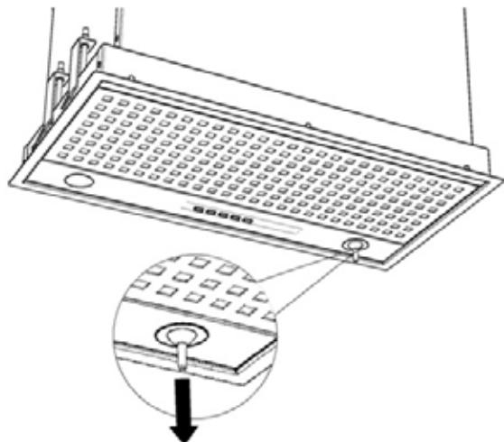
Une ventouse est fournie avec la hotte pour faciliter le retrait des lampes. Placez la ventouse sur la lampe halogène et tirez celle-ci vers vous. La lampe se dégage de son support. Vous pouvez également installer la nouvelle lampe à l'aide de la ventouse.
