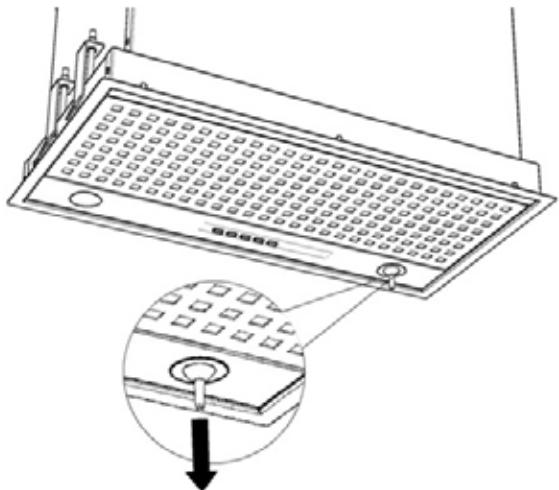
Mit der Dunstabzugshaube wurde ein kleiner Saugnapf zum Herausnehmen der Lampen mitgeliefert. Ziehen Sie das Leuchtmittel mit dem mitgelieferten Saugnapf vorsichtig nach unten heraus und setzen mit dem Saugnapf eine neue Lampe ein.
