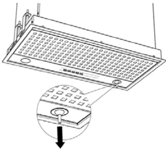
Bij de afzuigkap is een zuignapje geleverd voor het verwijderen van de lampen. Plaats het zuignapje op de halogeenspot en trek deze neer u toe. De lamp komt er nu uit. De nieuwe lamp kunt u ook met het zuignapje plaatsen.
