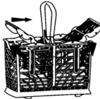
Handeling voor het er uit trekken van de insteekstukker
