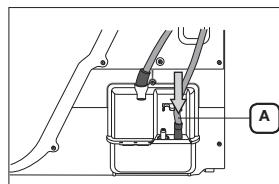
3. Raccordez le tuyau fourni (tuyau de vidange long) B à l'orifice situé à côté de celui où est raccordé le tuyau de vidange A.
