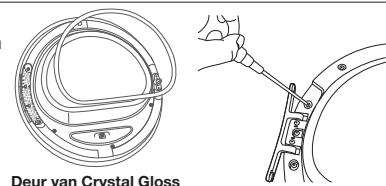
5. Nadat de schroeven zijn verwijderd, draait u de scharnierdeur van de installatie, de deur met de handgreep 180°, zoals wordt weergegeven in de afbeelding.
