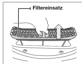
2. Öffnen und reinigen Sie den Filtereinsatz.
