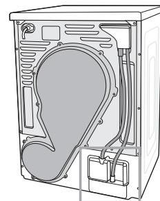
1. Lösen Sie den Abwasserschlauch **A**.
