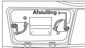
3. Verwijder het warmtewisselaarfilter.
