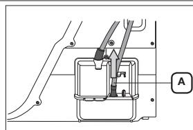
2. Schließen Sie den Abwasserschlauch **A** an den anderen Stutzen an.
