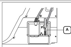
3. Schließen Sie den Zubehörschlauch (langer Abwasserschlauch) **B** an den Stutzen neben dem an, an dem der Abwasserschlauch angeschlossen ist **A**.
