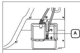
2. Sluit de afvoerslang aan **A** op de andere opening.
