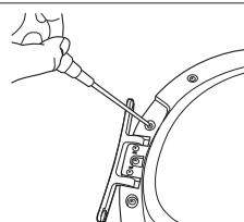
8. Verplaats de positie van de schroef aan de achterzijde van het scharnier.
