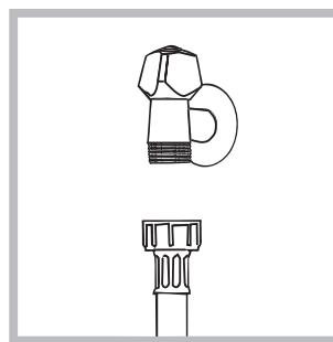
1. Schrauben Sie den Wasserschlauch an einen Kaltwasserhahn mit 3/4-Zoll-Gewindeanschluss an (siehe Abbildung). Lassen Sie das Wasser vor dem Anschluss so lange auslaufen, bis klares Wasser austritt.
