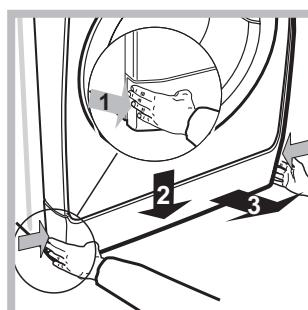
1. verwijder het afdekpaneel aan de voorzijde van de Wasdroogmachine door er op het midden op te drukken. Duw beide zijkanten naar beneden toe en verwijder het paneel (zie afbeeldingen).
