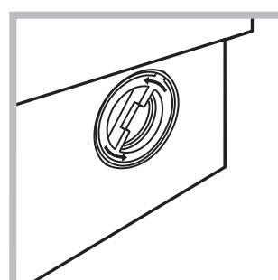
2. deșurubați capacul rotindu-l în sens antiorar (a se vedea figura). Este normal să iasă puțină apă;
