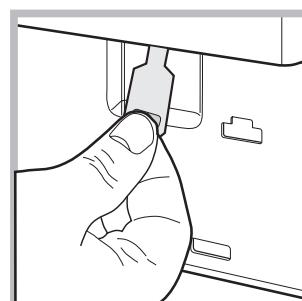
4. utilizând dispozitivul indicat în figură, trageți spre dumneavoastră până când eliberați tirantul de plastic din opritor; trageți apoi în jos și, în același timp, deschideți ușa.
