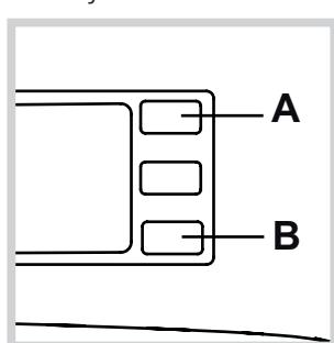
Om dit programma te activeren drukt u tegelijkertijd 5 sec. op de toetsen **A** en **B** (zie afb.). Het programma start automatisch en heeft een duur van circa 70 minuten. Om de cyclus te beëindigen drukt u op de toets START/PAUSE.
