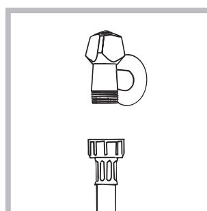
1. Conectați furtunul de alimentare, însurubându-l la un robinet de apă rece cu gura filetată de l' gaz (a se vedea figura). Înainte de conectare, lăsați apa să curgă până când nu a devenit împedite.
