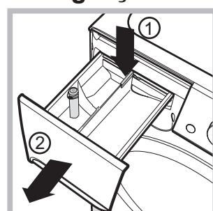
Pentru a scoate sertarul, apăsați pe levierul (1) și trageți-l spre exterior (2) (a se vedea figura). Spălați-l sub un jet de apă; această operație trebuie efectuată cât mai des posibil.
