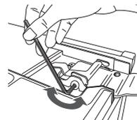
3. Drehen Sie den Bolzen im Uhrzeigersinn, um den Abstand zu vergrößern (↻). Drehen Sie den Bolzen gegen den Uhrzeigersinn, um den Abstand zu verringern (↻).
