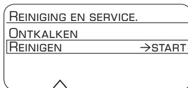
Gedurende de afzonderlijke reinigingsstappen, knippert toets **8 start**. De getallen rechtsboven aan geven aan hoe ver het proces is.
