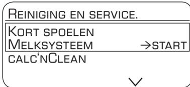
Het melksysteem **10** kan automatisch worden voorgereinigd.
