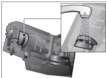
**Belangrijk:** Gebruik bij het reinigen geen spoel- of reinigingsmiddelen en was de zetgroep niet in de vaatwasser.
