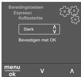
Afb. 6: Voorbeeld: display met bedieningstoetsen
